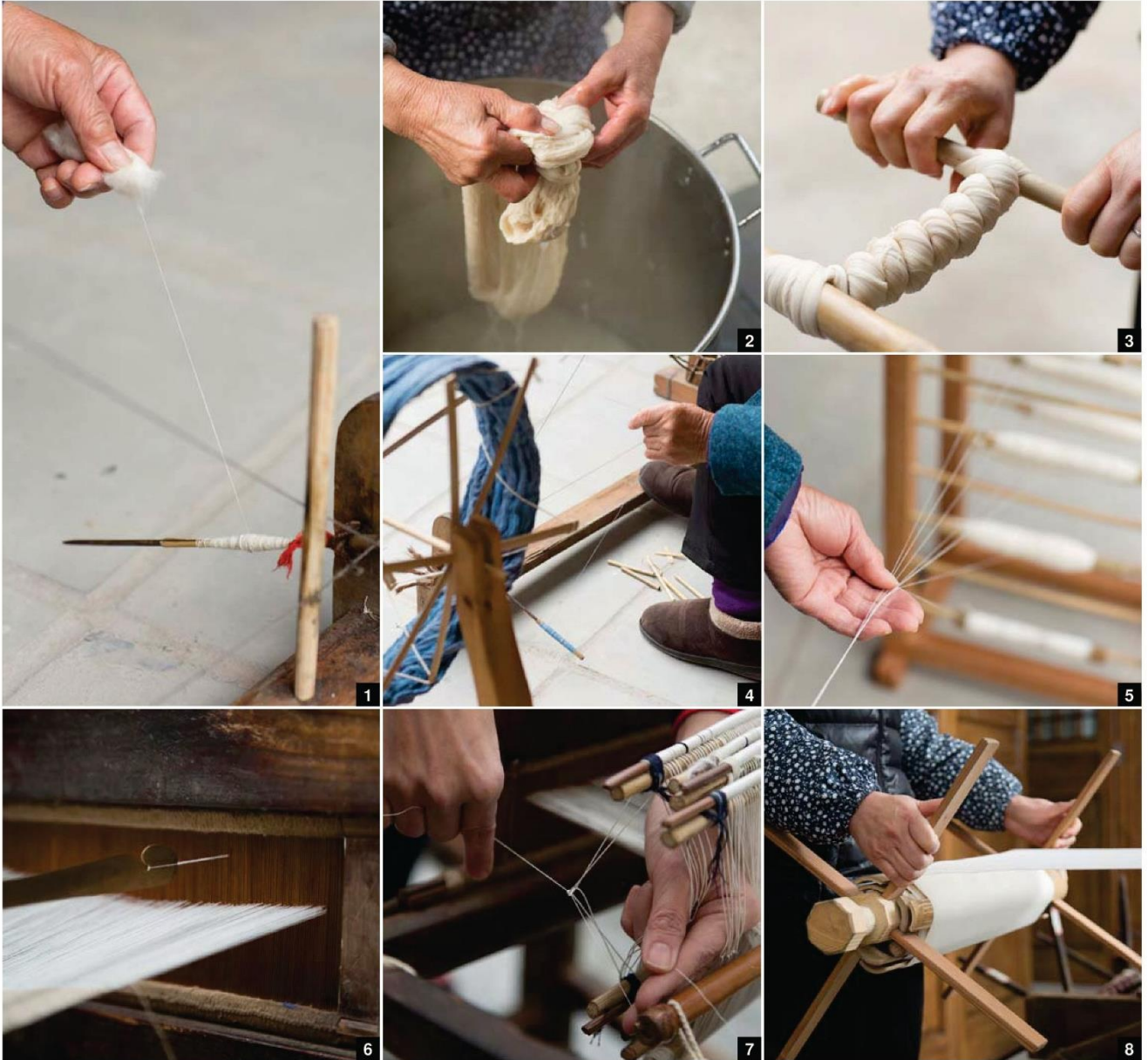
1. 纺纱。2. 浆纱。3. 晒干。4. 打筒。5. 牵经线。6. 穿箱。7. 穿综。8. 卷经。9. 金泽馆藏织布机模型。
